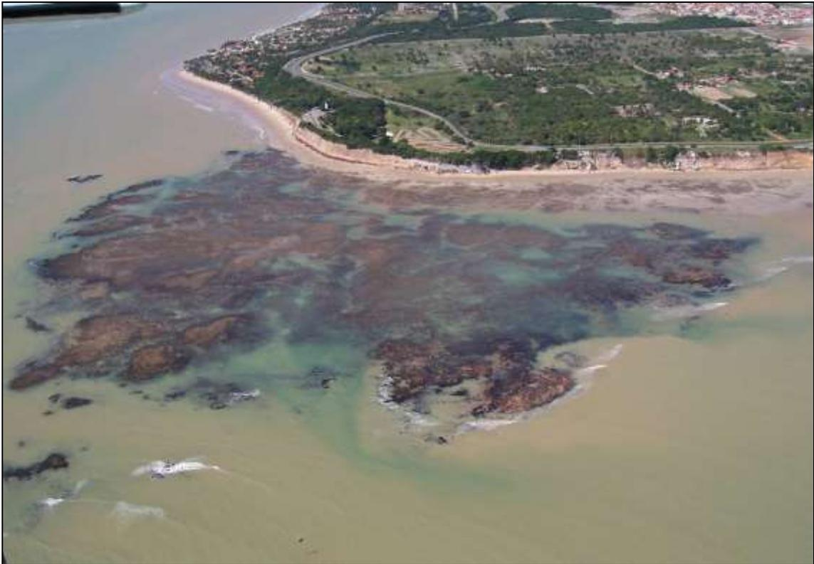
**FIGURA 23:** Vista geral da Área de Influência Direta (AID). Em primeiro plano a plataforma de abrasão formada por sedimentos ferruginosos que protegem a Ponta do Cabo Branco da ação direta das ondas. **Foto:** FADURPE/SEMAM
