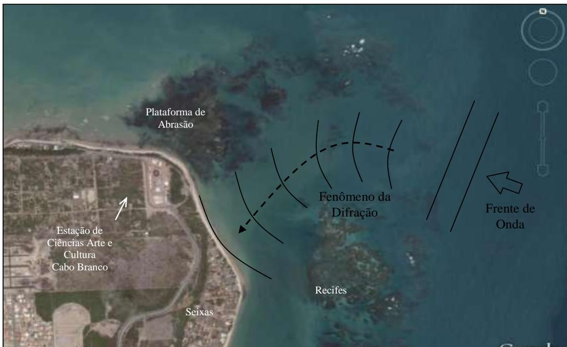
**FIGURA 43:** Recife semi-submerso interrompido provoca refração nas ondas que passam pelo canal formado com a plataforma de abrasão o que resulta em uma praia em forma de arco.
