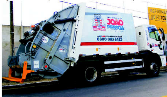
Figura 62 - Caminhão compactador utilizado na coleta domiciliar no município de João Pessoa
