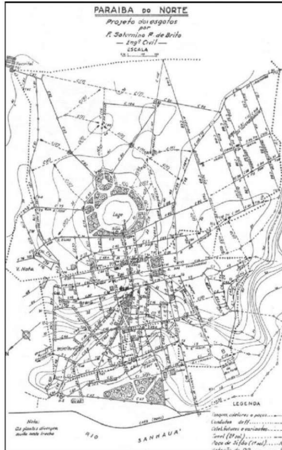
Figura 38 - Plano Geral dos Esgotos da Capital Paraibana Proposto por Saturnino de Brito, em 1913
