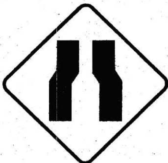
A - 21a Estreitamento de pista ao centro
